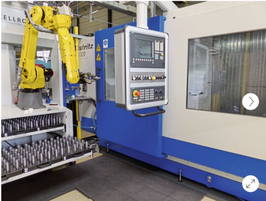
Mit der Wirbelmaschine LWN 120 von Leitzrit wollte man die Vorteile des Wirbels mit einem schnelleren Umrüsten und ei-ner mannlosen Fertigung verbinden. (Bild: Uttec)
