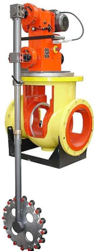
DM 2 fornita di azionamento ad aria compressa montato con collare per tubi e tensionatore a catena
